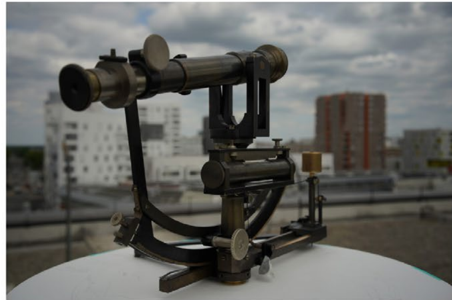
Relevés de terrain sur les toits d'Évry-Courcouronnes avec l'orographe
